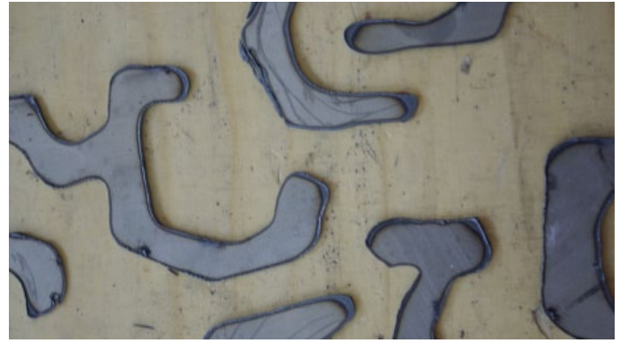
Modellen van patroon kunnen grafisch worden gebruikt: in dunne staal plaat, handmatig uitgesneden met een plasmasnijder.
