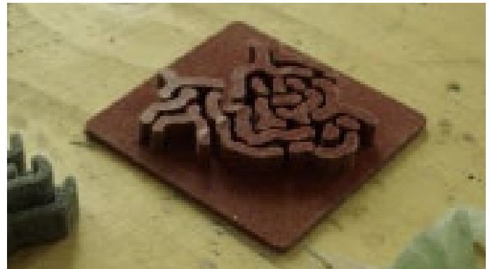
Een model in rubber, uitgefreesd in schuim, met siliconenrubber gegoten.
