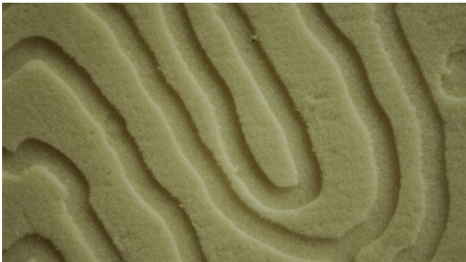
In de uitgeprobeerde modellen is het oppervlak iets ingefreesd, aan beide zijdes, in verschillende patronen.
