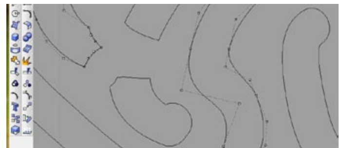
Geexporteerd als dxf: lijn kan eventueel in ander programma als Rhino bij worden gewerkt of in illustrator verder worden bewerkt met smooth of pen tool
